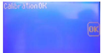
17. Nach Abschluss der Kalibrationsroutine kehrt das Gerät in das Hauptmenü zurück. Dort können Sie die eingestellten Parameter überprüfen, ändern, eine erneute Kalibration ausführen oder auf den Hauptbildschirm zurückkehren. Die pH / Redox-Pumpe ist nun einsatzbereit
