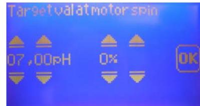
8. Das Gerät verlangt nun nach der Eingabe des Maximalen Messwertes und der damit verbundenen Drehzahl. Drehzahlen < 10% sind nicht vorgesehen.
